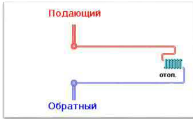
Рисунок 7.3. Местный тепловой пункт с открытым водоразбором.
