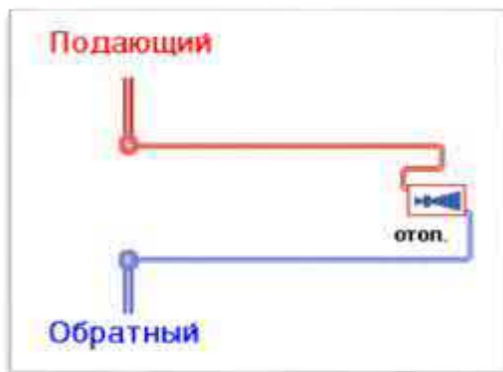
Рисунок 7.4. Местный тепловой пункт с открытым водоразбором.
