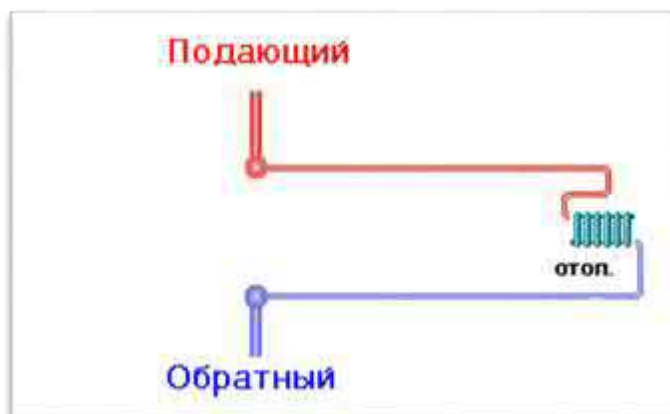
Рисунок 7.3. Местный тепловой пункт с открытым водоразбором.
