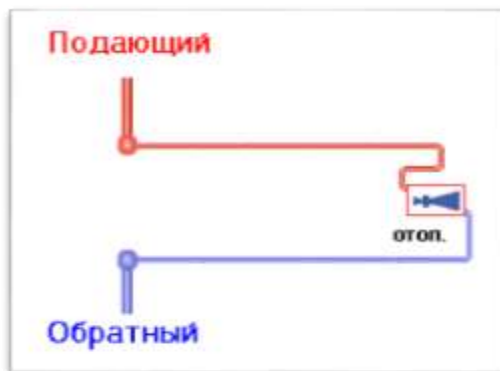
Рисунок 7.4. Местный тепловой пункт с открытым водоразбором.
