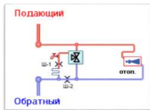
Рисунок 7.5. Местный тепловой пункт с открытым водоразбором и циркуляционной линией
