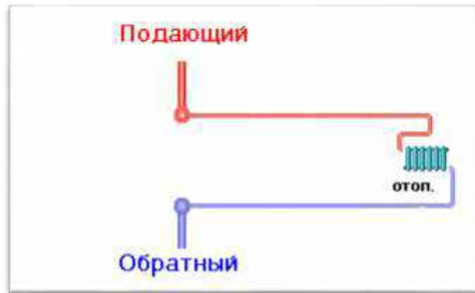
Рисунок 7.3. Местный тепловой пункт с открытым водоразбором.
