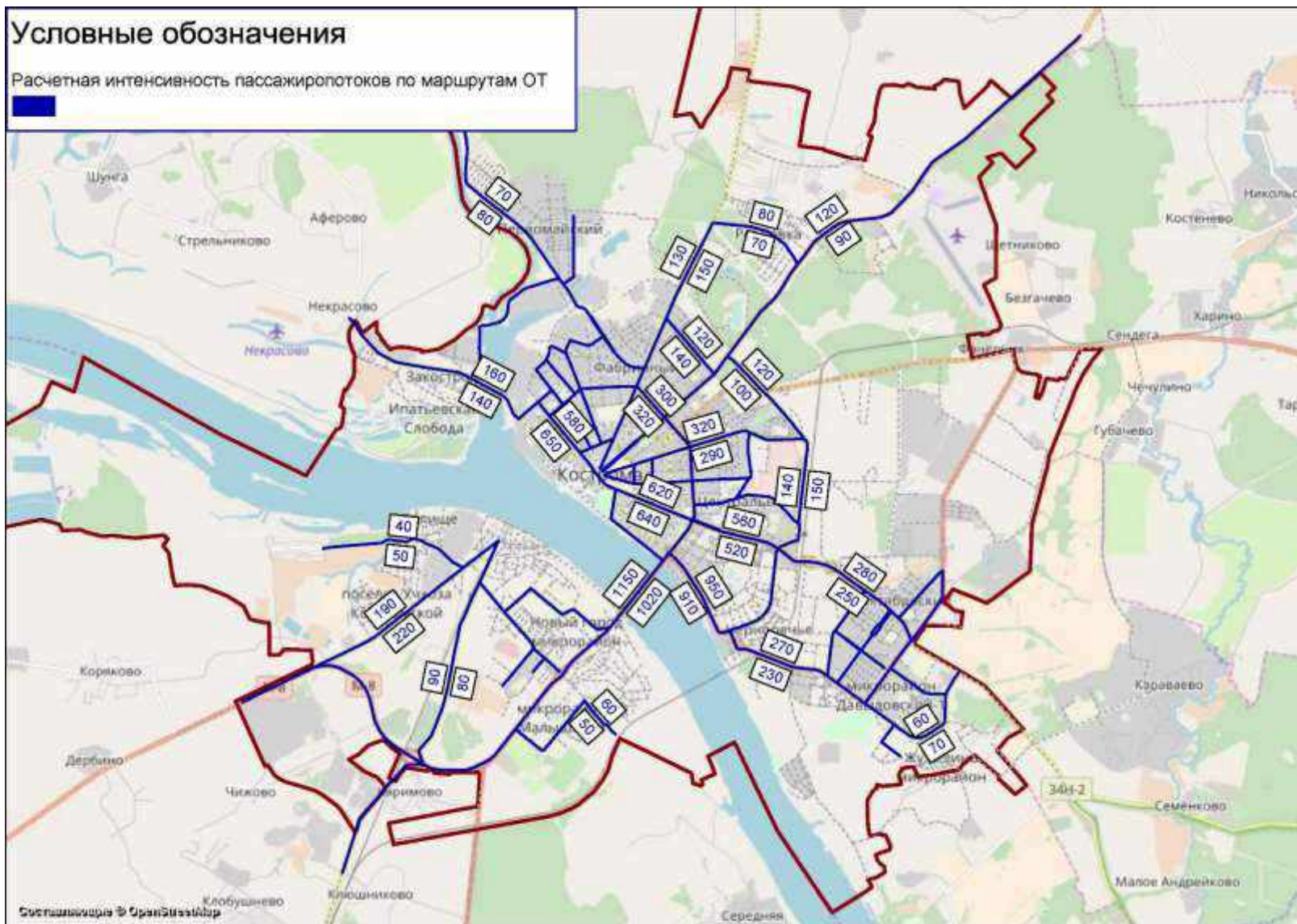
Рисунок 21 – Картограмма расчетной интенсивности пассажиропотоков по маршрутам ОТ в час пик
