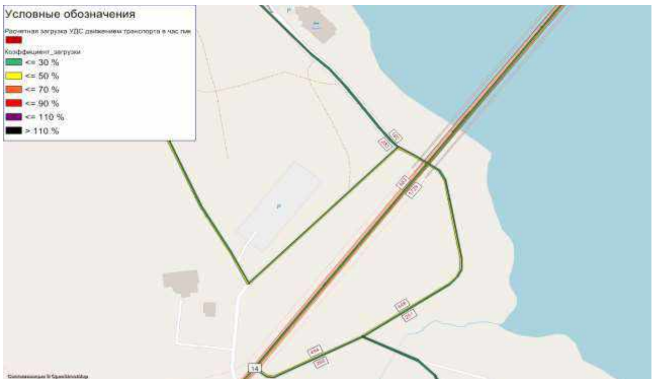
Рисунок 56 – Картограмма расчетной загрузки УДС с указанием интенсивности движения транспорта на пересечении ул. Магистральная – ул. Набережная – ул. Пантусовская, прогноз
