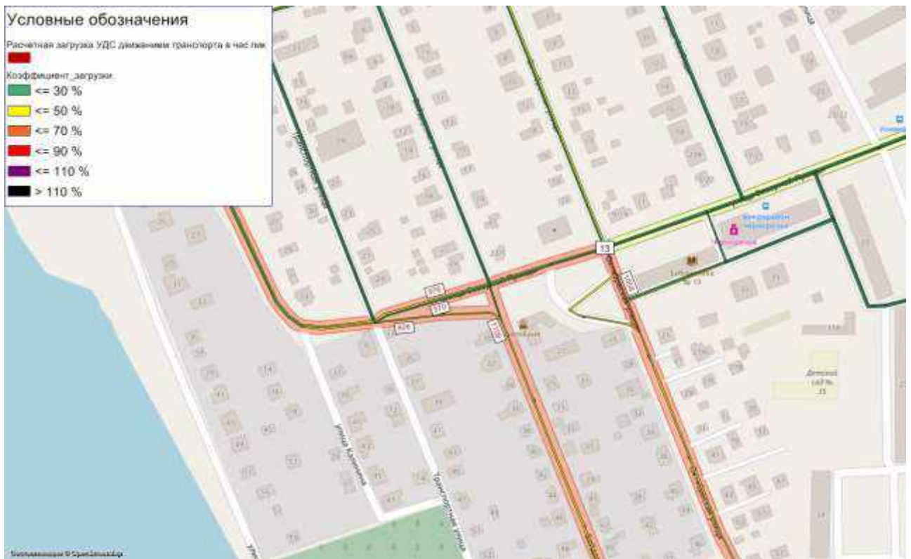
Рисунок 53 – Картограмма расчетной загрузки УДС на пересечении ул. Северной Правды – ул. Октябрьская, существующее положение
