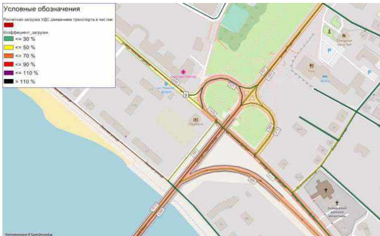
Рисунок 45 – Картограмма расчетной загрузки УДС с указанием интенсивности движения транспорта на пересечении ул. Нижняя Дебря в районе выезда на ул. Подлипаева (Волжский мост), существующее положение
