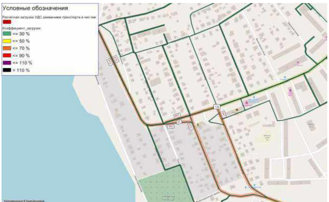
Рисунок 54 – Картограмма расчетной загрузки УДС на пересечении ул. Северной Правды – ул. Октябрьская, прогноз
