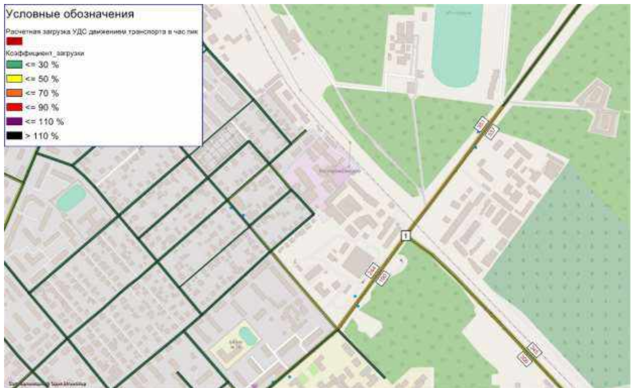
Рисунок 29 – Картограмма расчетной загрузки УДС с указанием интенсивности движения транспорта на пересечении проспект Мира – ул. Юрия Смирнова, существующее положение
