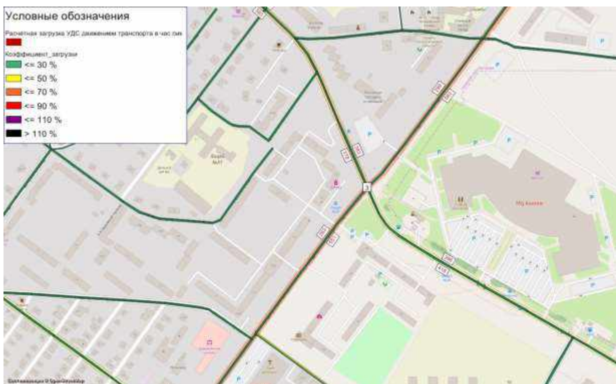
Рисунок 34 – Картограмма расчетной загрузки УДС с указанием интенсивности движения транспорта на пересечении Кинешемское шоссе – ул. Индустриальная, прогноз
