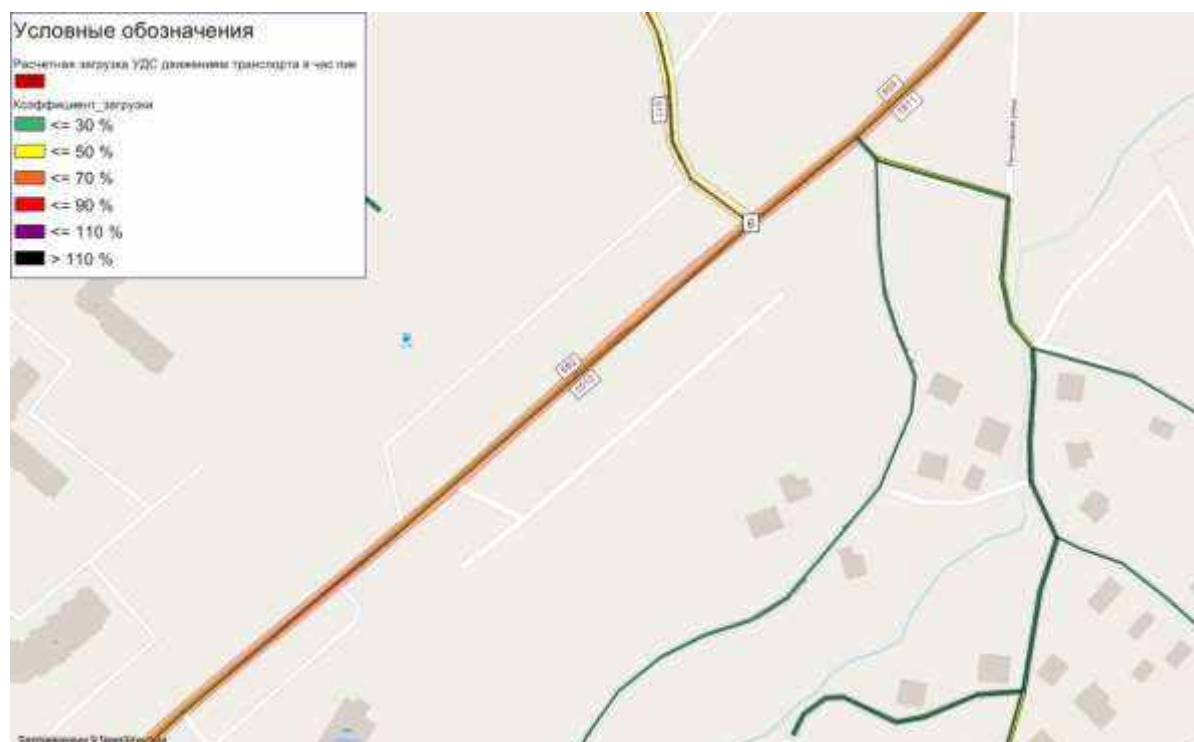
Рисунок 39 – Картограмма расчетной загрузки УДС с указанием интенсивности движения транспорта на пересечении ул. Ермакова – ул. Магистральная, существующее положение
