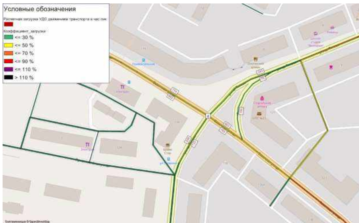
Рисунок 35 – Картограмма расчетной загрузки УДС с указанием интенсивности движения транспорта на пересечении ул. Титова – ул. Советская, существующее положение
