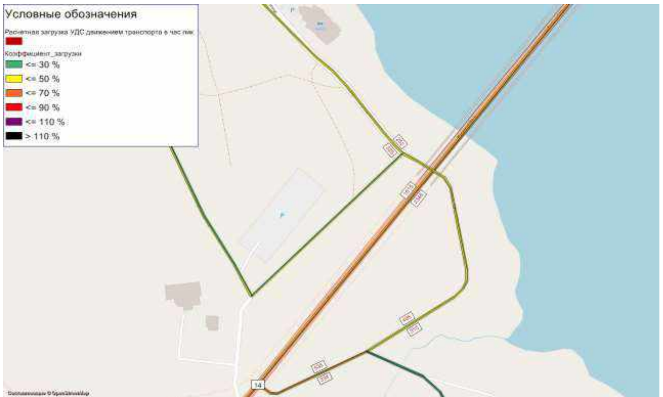
Рисунок 55 – Картограмма расчетной загрузки УДС на пересечении ул. Магистральная – ул. Набережная – ул. Пантусовская, существующее положение
