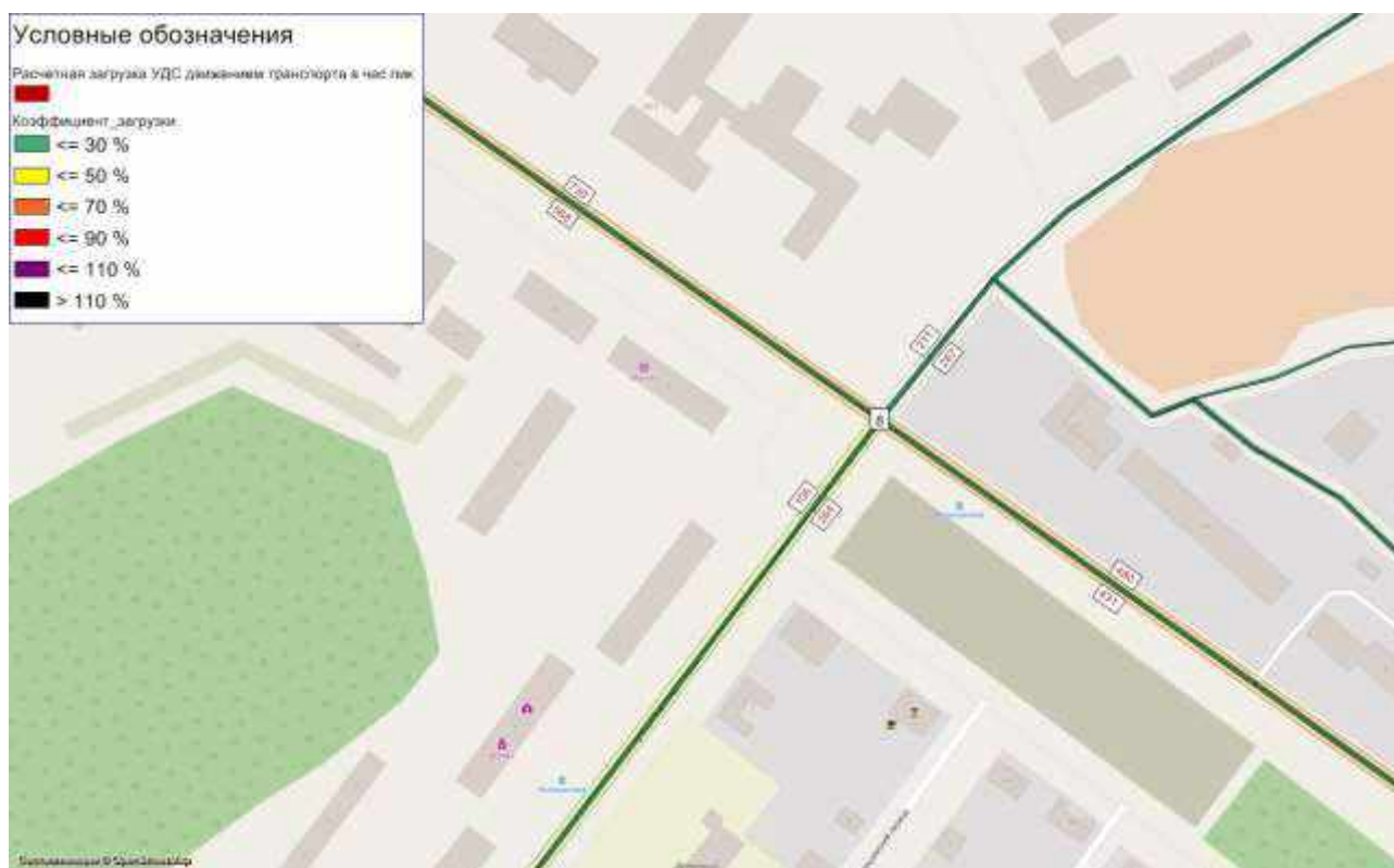
Рисунок 44 – Картограмма расчетной загрузки УДС с указанием интенсивности движения транспорта на пересечении Кинешемское шоссе – ул. Димитрова – ул. Станкостроительная, прогноз
