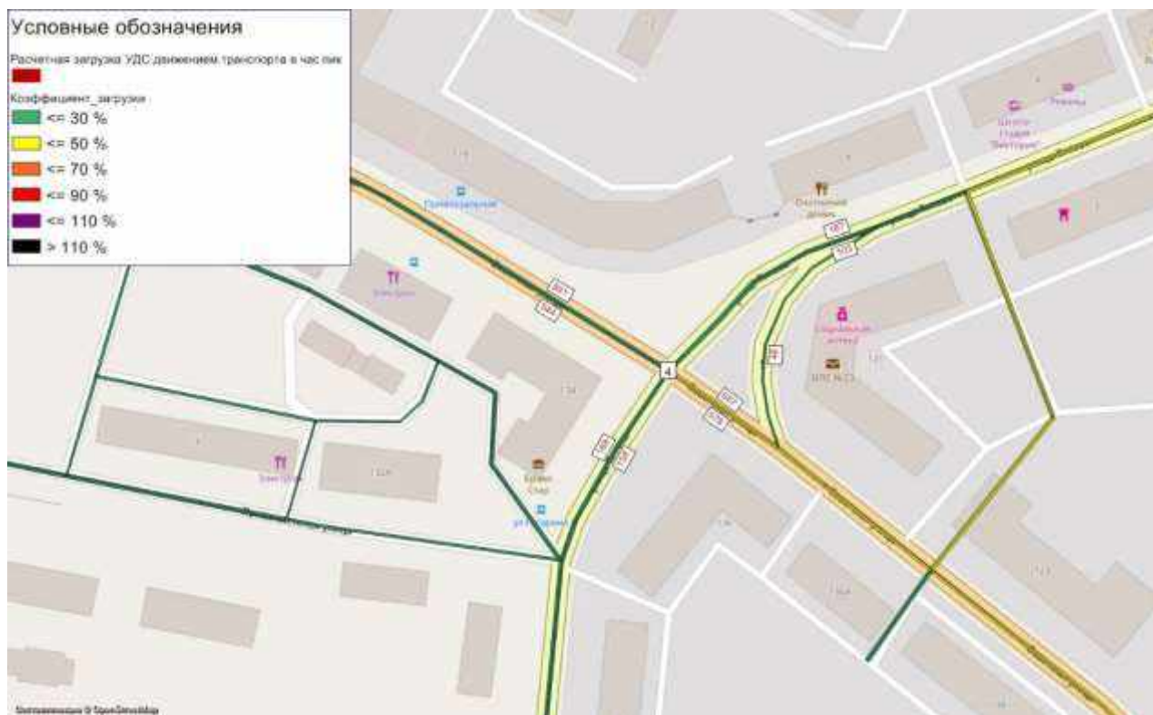
Рисунок 36 – Картограмма расчетной загрузки УДС с указанием интенсивности движения транспорта на пересечении ул. Титова – ул. Советская, прогноз
