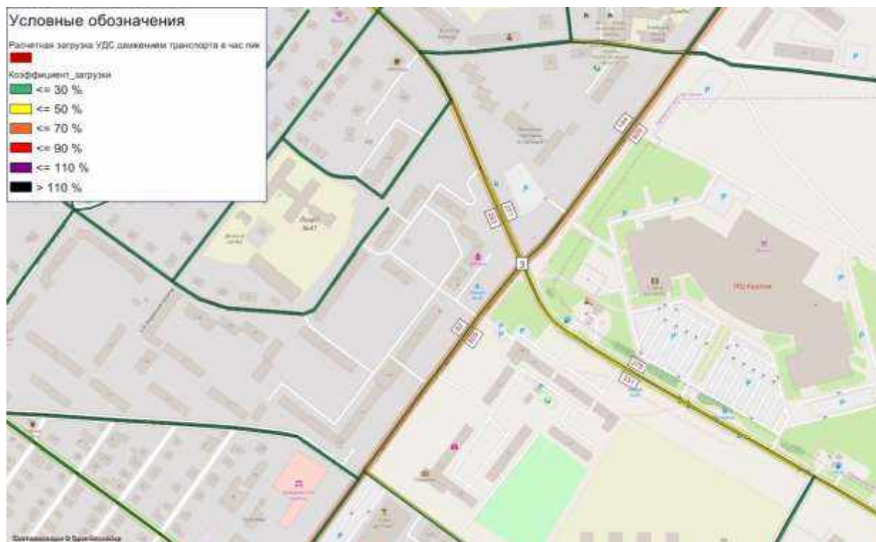
Рисунок 33 – Картограмма расчетной загрузки УДС с указанием интенсивности движения транспорта на пересечении Кинешемское шоссе – ул. Индустриальная, существующее положение
