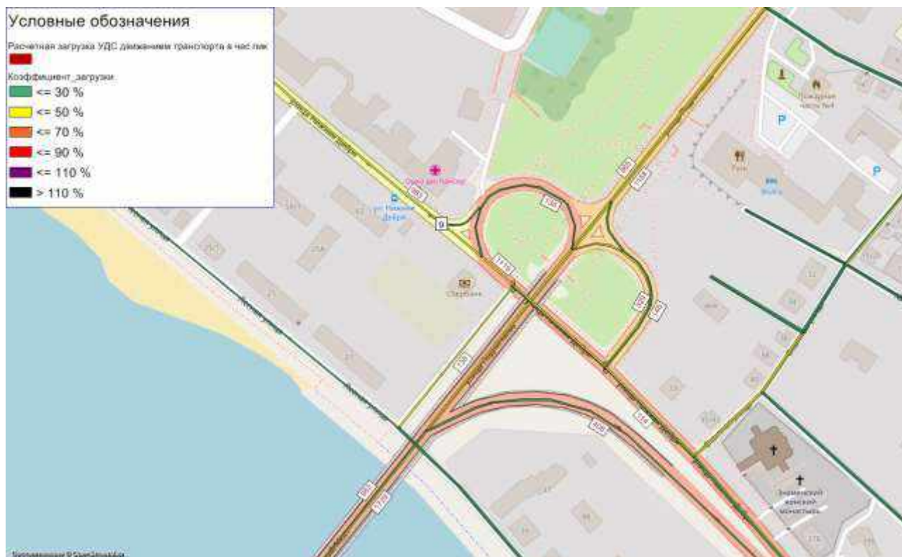
Рисунок 46 – Картограмма расчетной загрузки УДС с указанием интенсивности движения транспорта на пересечении ул. Нижняя Дебря в районе выезда на ул. Подлипаева (Волжский мост), прогноз
