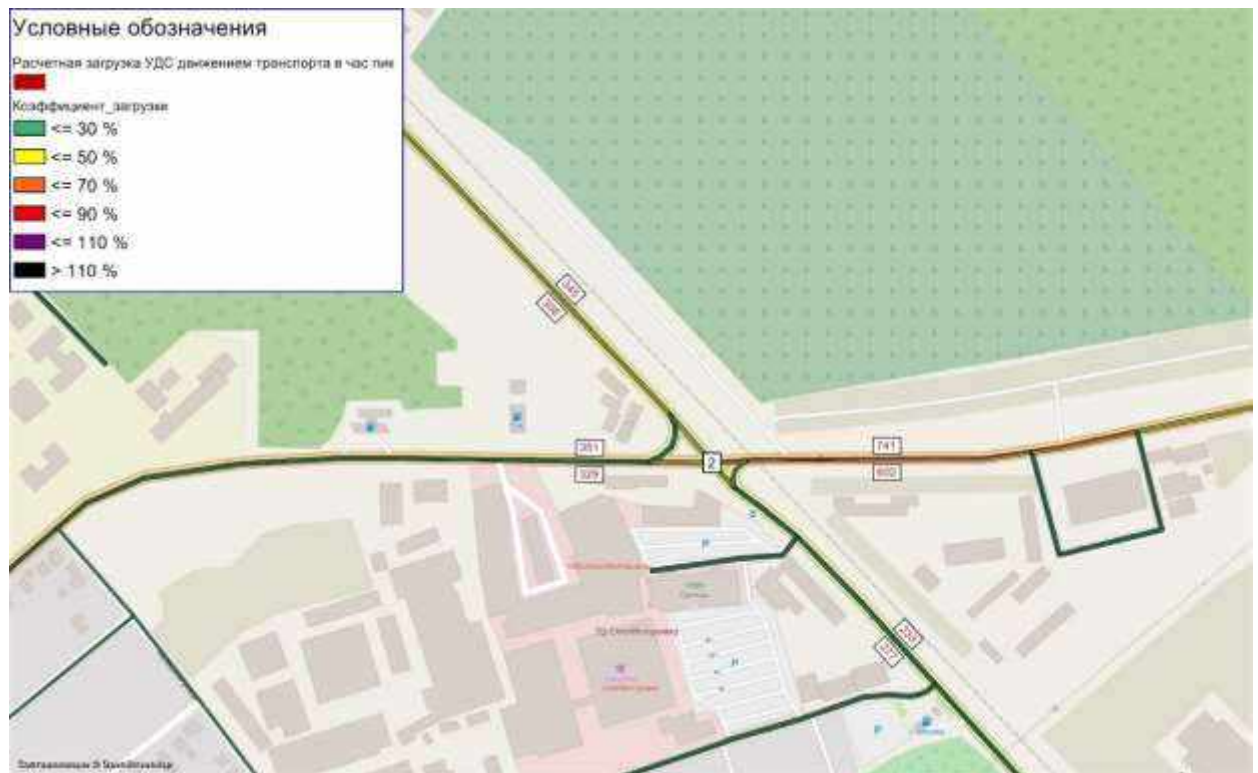
Рисунок 31 – Картограмма расчетной загрузки УДС с указанием интенсивности движения транспорта на пересечении ул. Галичская – ул. Юрия Смирнова, существующее положение
