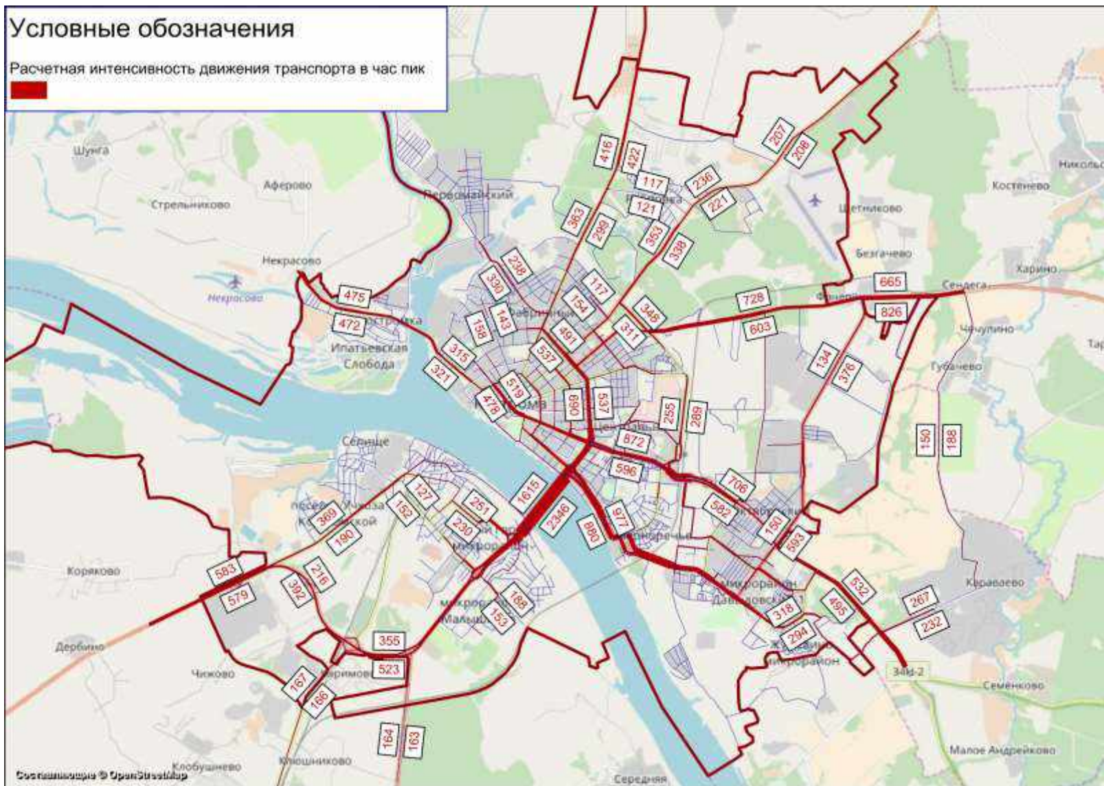
Рисунок 19 – Картограмма расчетной интенсивности движения транспорта в час пик
