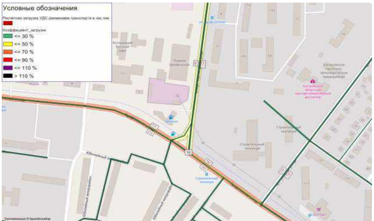
Рисунок 60 – Картограмма расчетной загрузки УДС с указанием интенсивности движения транспорта на пересечении ул. Профсоюзная – ул. Димитрова, прогноз
