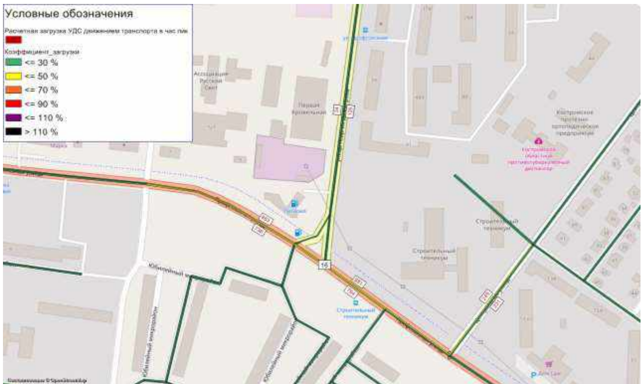
Рисунок 59 – Картограмма расчетной загрузки УДС с указанием интенсивности движения транспорта на пересечении ул. Профсоюзная – ул. Димитрова, существующее положение
