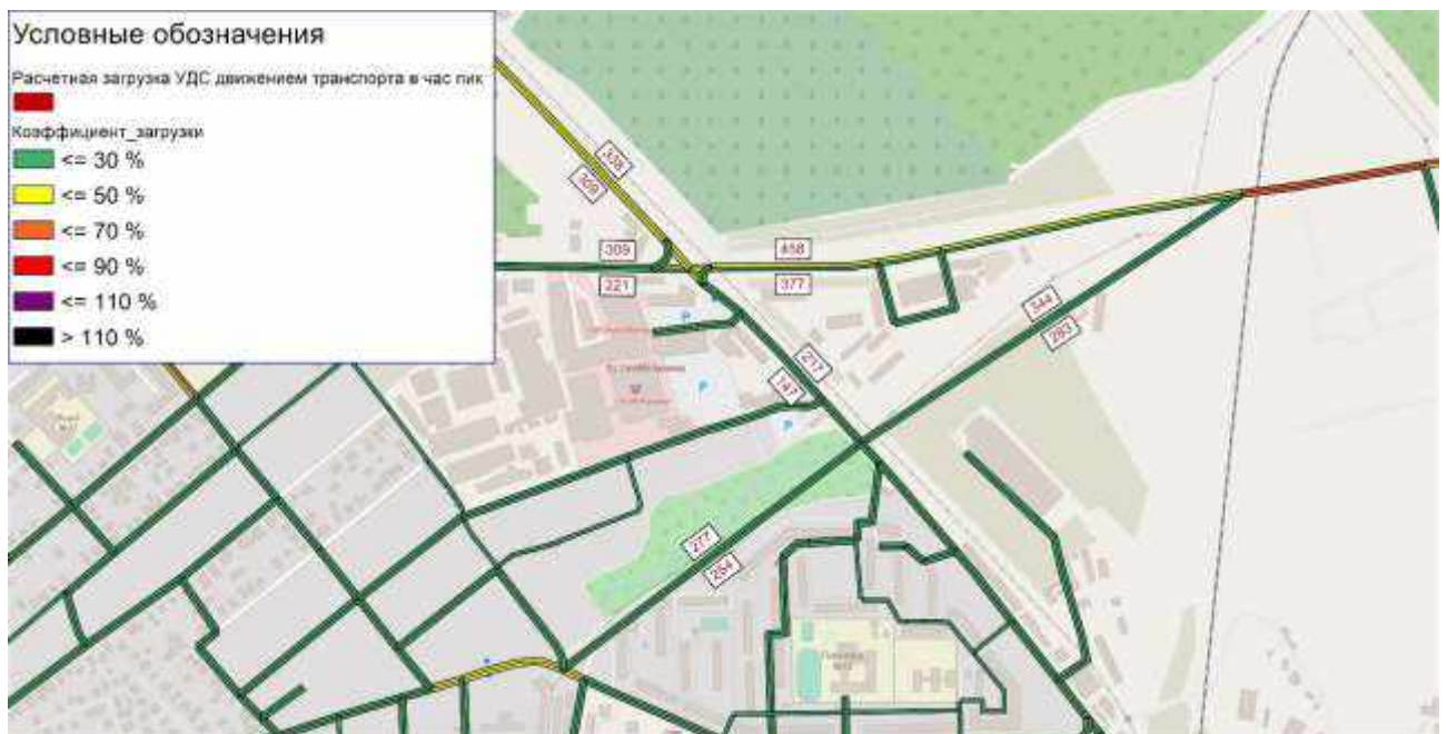
Рисунок 32 – Картограмма расчетной загрузки УДС с указанием интенсивности движения транспорта на пересечении ул. Галичская – ул. Юрия Смирнова, прогноз
